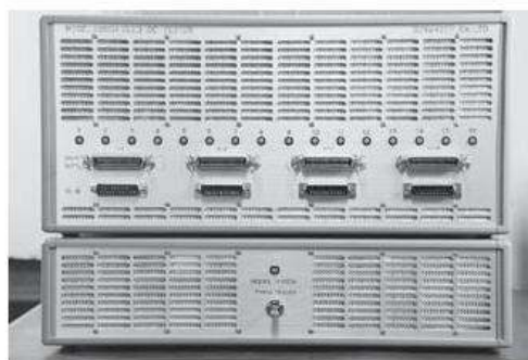
写真4 大電流DC寿命試験装置「MODEL2805H」
