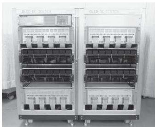
写真3 DC駆動寿命試験装置とデバイスホルダ「MODEL2805B」（128CHシステム）
